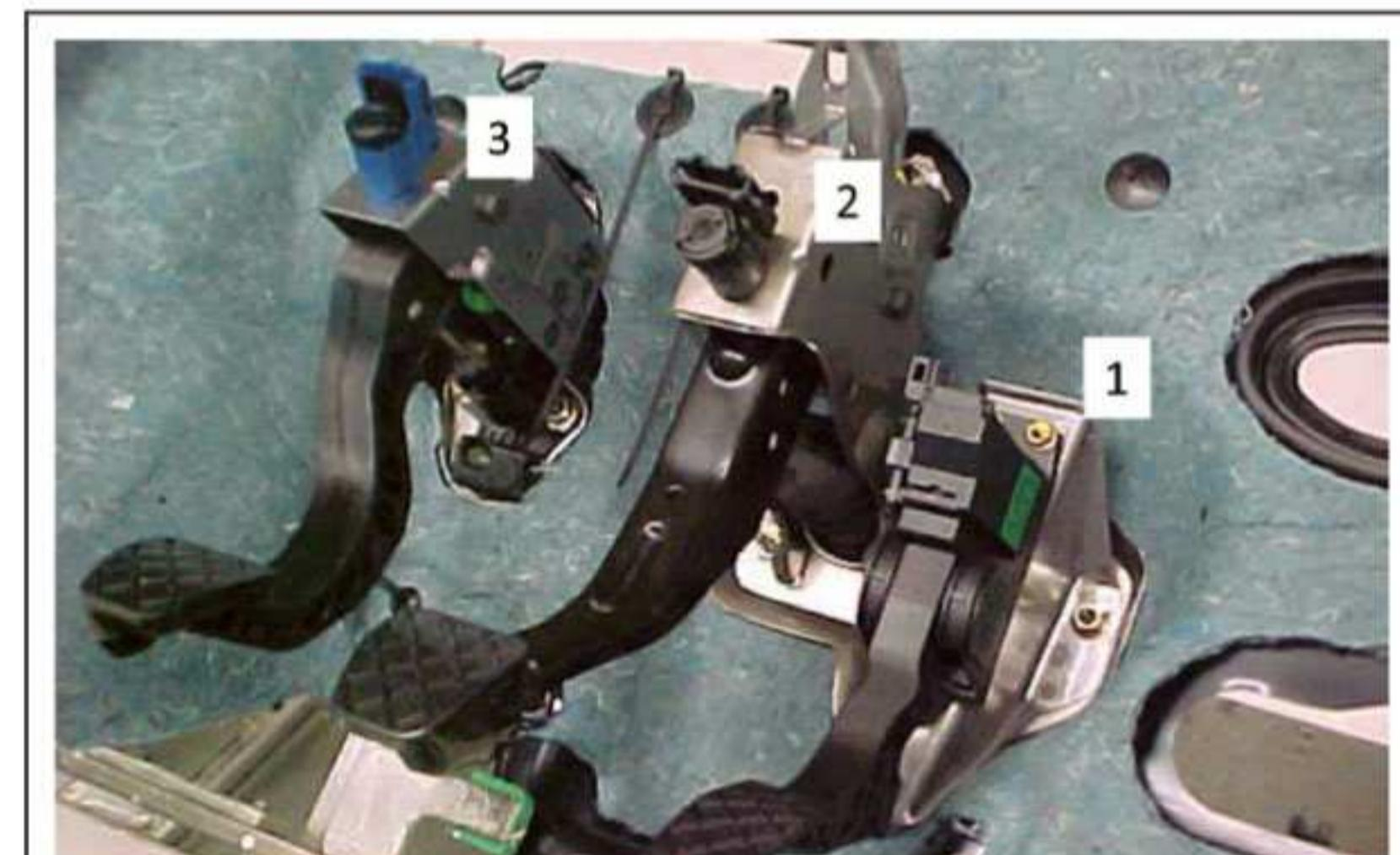
1. Sensor de posição do pedal do acelerador eletrônico com os sensores G79 e G185 (conector com 6 pinos).
